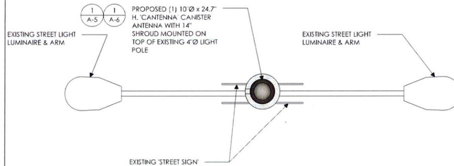
A. SECTION (CANISTER ANTENNA)
