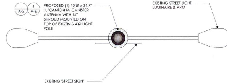
A. SECTION (CANISTER ANTENNA)
